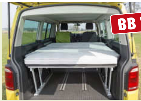
Für ein topfebenes Bett muss das Originalpolster auf dem Multiflexboard bleiben.
