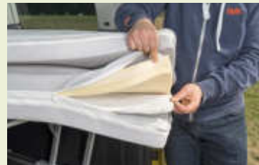
Zweilagiger Schaumstoff, Unterpolsterung – BB Walder baut das Luxusbett.
